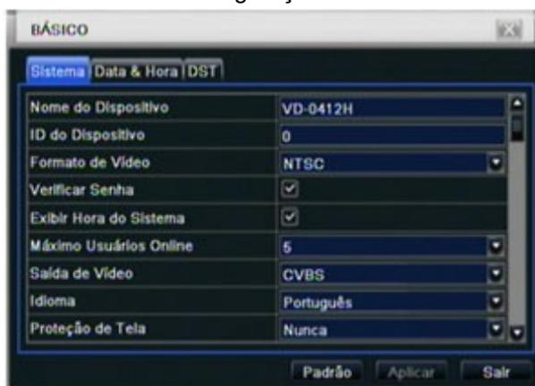
Fig. 3.3 Configurações Básicas do Sistema
