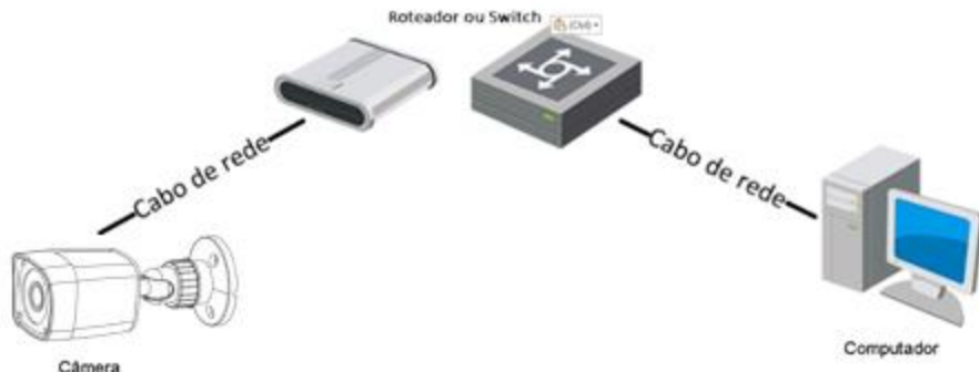
Figura 3.1 – Conexão via Rede LAN
