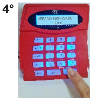
Outra maneira de alterar o ID do teclado, porém, com ele já conectado e ativo no sistema, é acessando o sistema com a senha de **INSTALADOR** (nível 0), entrar no menu programação e ir até o item 12 (ID Teclado). Neste item, pode ser visualizado o ID programado e também alterá-lo.
